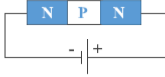
Resim 4.5: NPN Transistör Devre Bağlantısı
