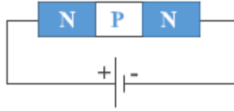
Resim 4.6: NPN Transistör Devre Bağlantısı
