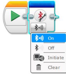
Resim 151. Bluetooth Connection/Bağlantı Bloğu
