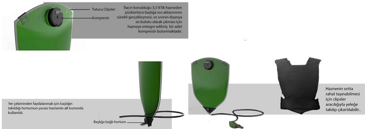
Şekil 3. Sıvının konulduğu, sırtta taşınabilir çanta hazne
