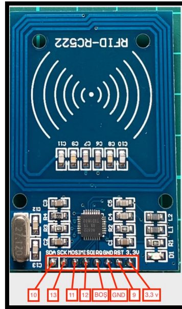
Resim 286. RC522 RFID NFC Kiti Bağlantı Uçları
