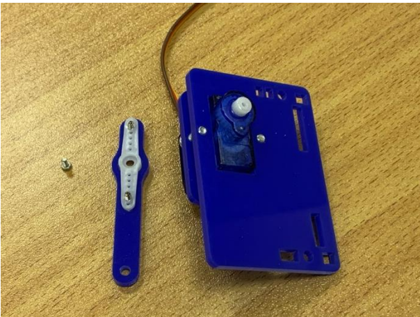
Vidalar sıkılarak motor karşılığı oluşturulur.
