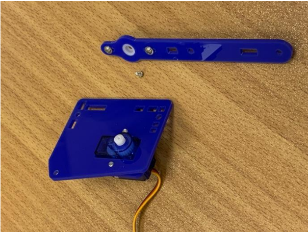
Motor karşılığı vidalar sıkılarak oluşturulur.
