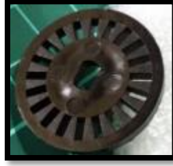
Resim 375. 20 Bölmeli Enkoder Disk
