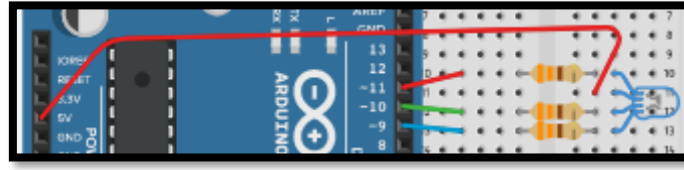
Resim 109. Ortak Anot RGB Örnek Devre Şeması
