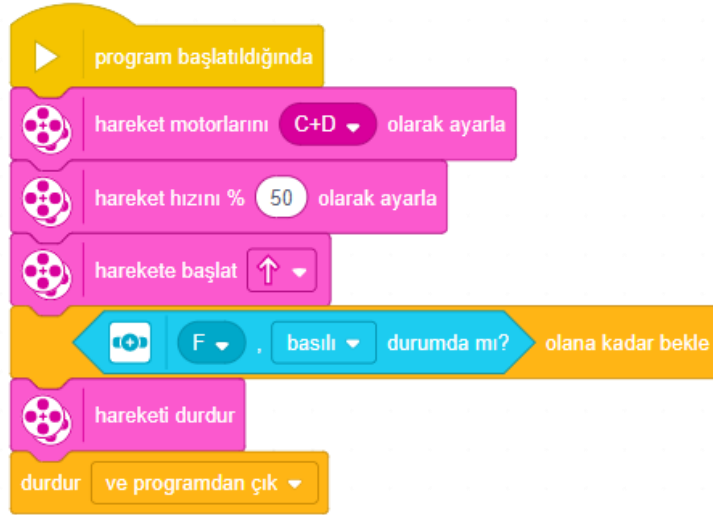
Resim 3.7 Engele Çarpınca Duran Robot Örnek Programı
