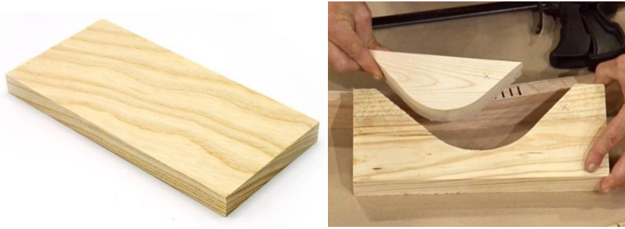
Şekil 2.10. Şerit testere veya dekupaj aleti ile yapılan kesmelere örnekler Düz kesim örneği (sol) (kaynak: https://www.woodworkerssource.com/lumber/ash.html ), Şekilli Kesim Örneği (sağ) (kaynak: http://woodworkingssession.com/how-to-cut-curves-in-wood/ ).
