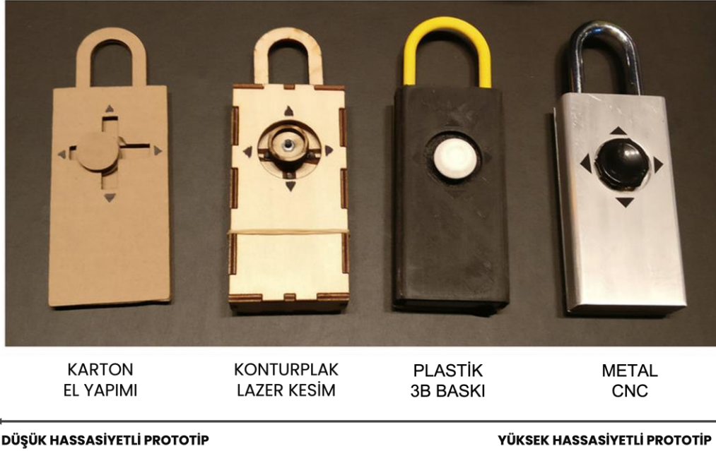
Şekil 2.3. Bir kilit tasarımı için yapılan ve farklı hassasiyet seviyelerinin sahip prototipler (kaynak: https://www.researchgate.net/figure/Photograph-of-the-four-prototypes-of-the-padlock-design-used-for-the-study-The-process_fig1_325135425 )
