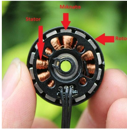
Bir Elektrik Motorunun İç Yapısı
