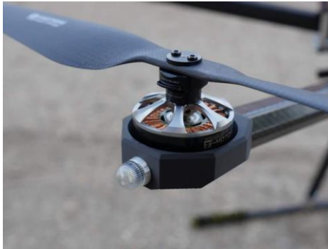
Döner Kanat ve Sabit Kanat İHA'lar İçin Motor Montajı
