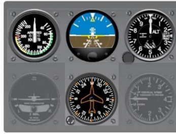
Şekil 8. Temel T Yerleşiminde Uçuş Göstergeleri
