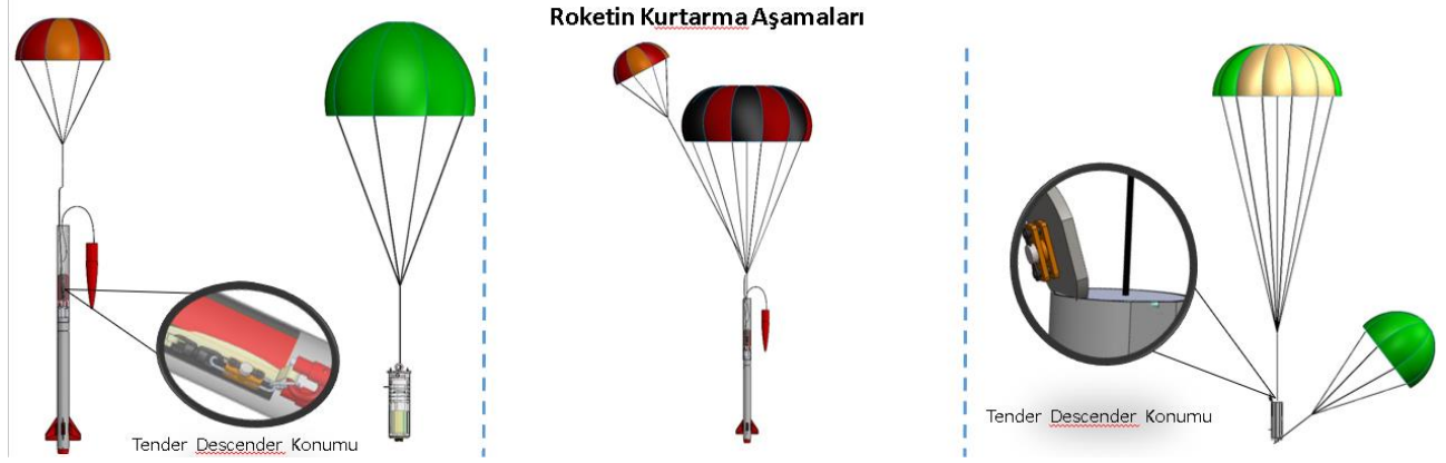
Şekil: Örnek Kurtarma Planlaması ve Örnek Kurtarma Sistemi
