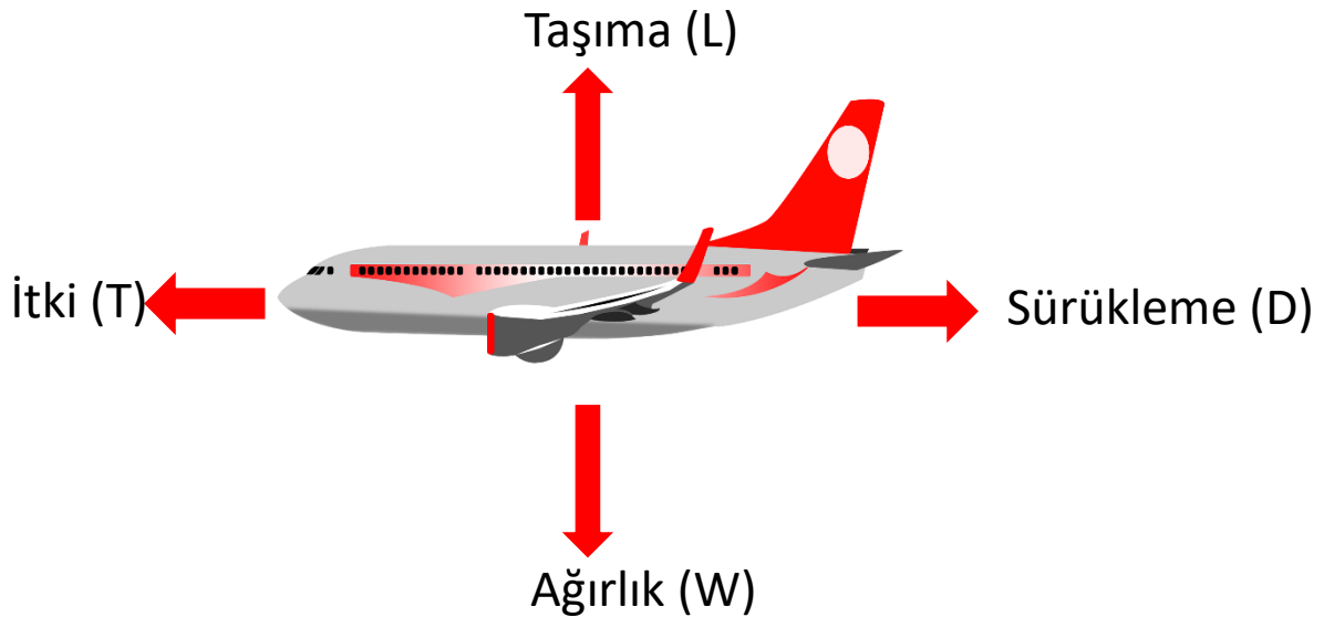
Şekil 5. Uçağa Etki Eden Temel Kuvvetler
