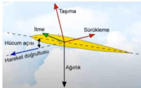
Bir Pervane Kesitine Etki Eden Kuvvetler
