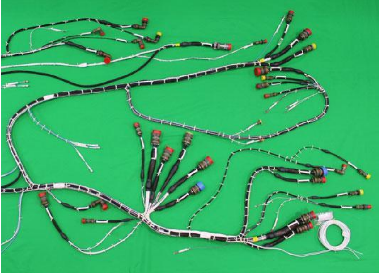
Şekil 6. Hava Araçlarında Kullanılan Konnektör ve Kablo Demeti Örnekleri
