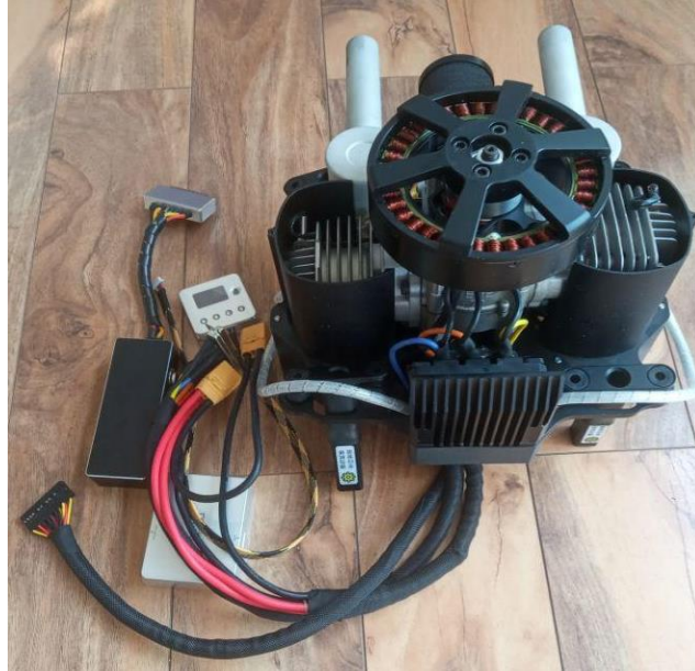
Hibrit İtki Sistemi Örneği: Elektrik Motoru ve Fosil Yakıtlı Motor
