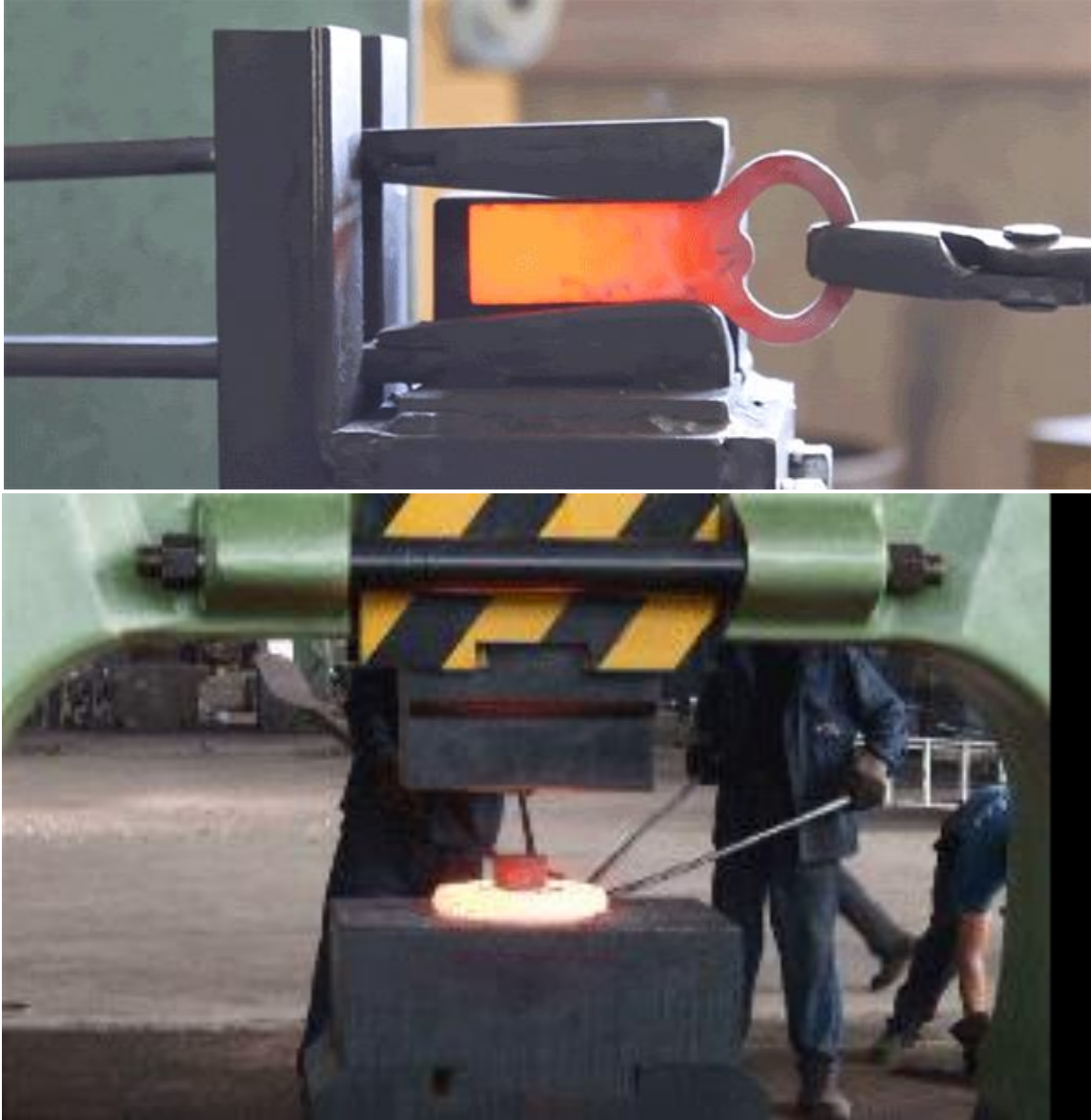
Şekil 1.11. Dövmе işleminin temel çalışma prensibi (kaynak: üst: https://gifer.com/en/BIXV , Alt: https://imgur.com/gallery/BaMaB )
