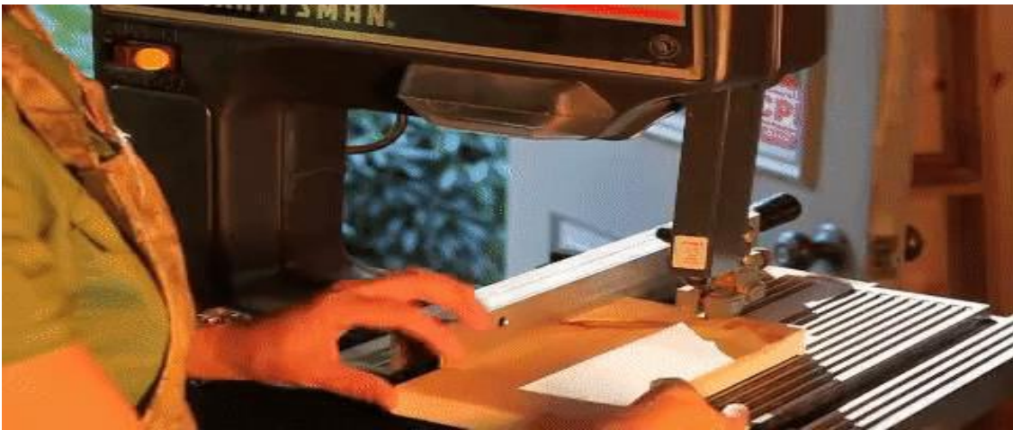
Şekil 1.2. Şerit kesme temel çalışma prensibi (kaynak: https://gfycat.com/shallowdampchihuahua )
