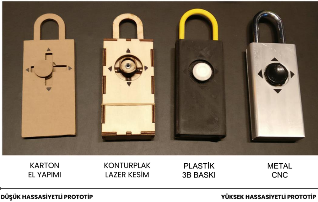
Şekil 2.3. Bir kilit tasarımı için yapılan ve farklı hassasiyet seviyelerin sahip prototipler (kaynak: https://www.researchgate.net/figure/Photograph-of-the-four-prototypes-of-the-padlock-design-used-for-the-study-The-process_fig1_325135425 )
