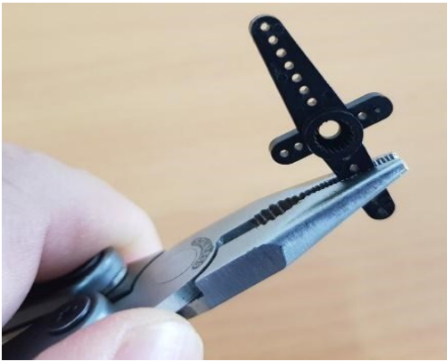
Resim 6.11. T-plastik parçanın uzun kenarları kırılarak elde edilen parça.
