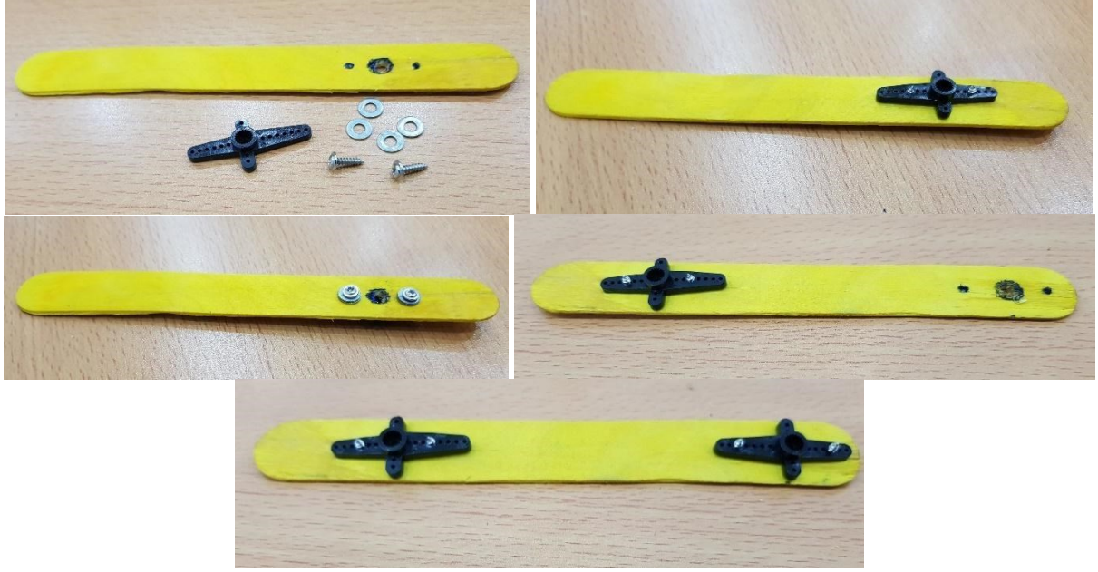
Resim 6.7. Abeslanglara servo motor T-plastik parçalarının takılması
