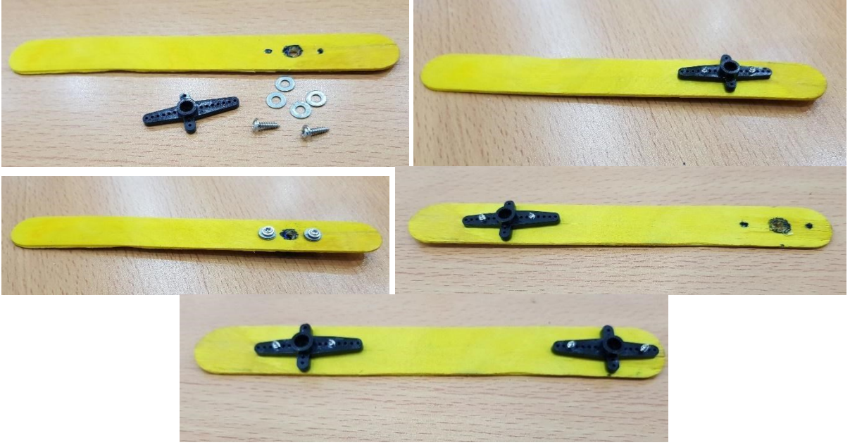
Resim 5.7. Abeslanglara servo motor T-plastik parçalarının takılması
