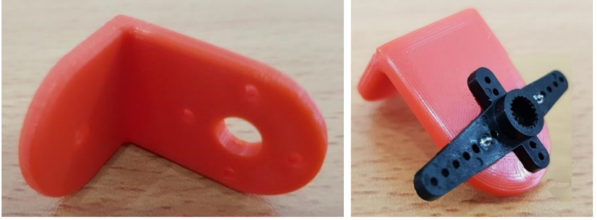
Resim 5.3. 3B-yazıcıda basılan L-profil ve üzerine vidalanmış servo motor plastik parçası
