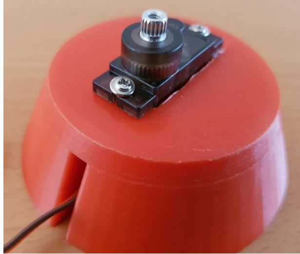
Resim 5.2. Taban parçaya vidalanmış servo motor
