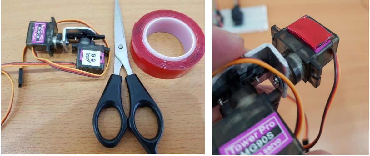
Resim 4.8. Çift taraflı silikon bant ve etiketin yapıştırılması
