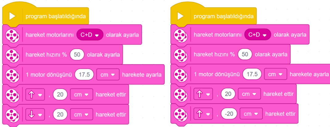
Resim 2.6 İleri ve Geri Hareket Eden Robot (iki alternatif yöntemle)
