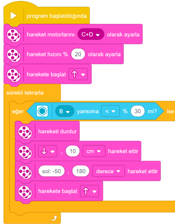
Resim 7.4 Çalışma Alanının İçinden Çıkmayan Robot Programı
