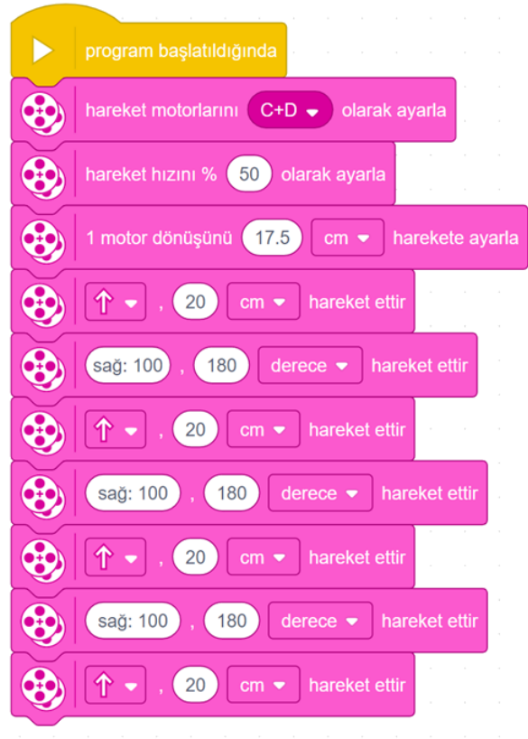
Resim 2.9 Kare Şeklinde Rotada Hareket Eden Robot
