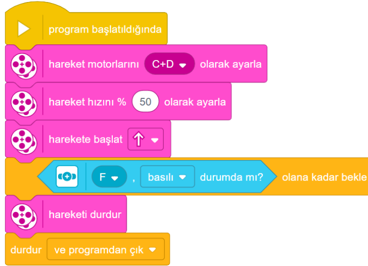
Resim 4.9 Engele Çarpınca Duran Robot Örnek Programı
