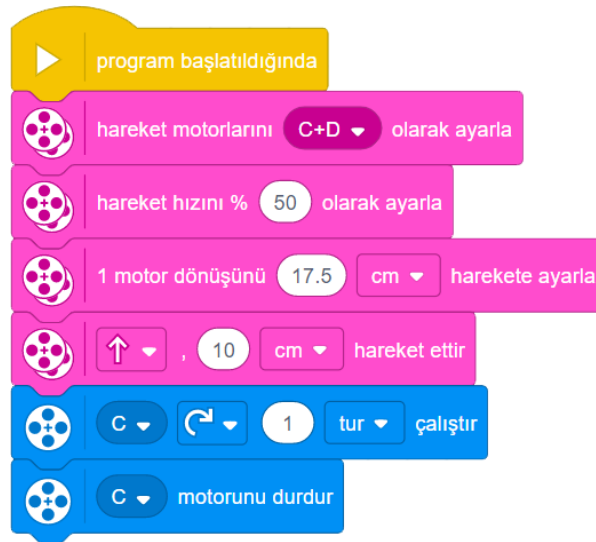
Resim 2.5 Temel Motor Blokları ve Ayarlanması
