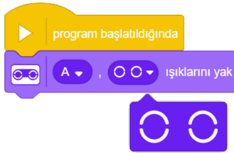
Resim 5.3 Mesafe Sensörünün Işıklarının Yakılması
