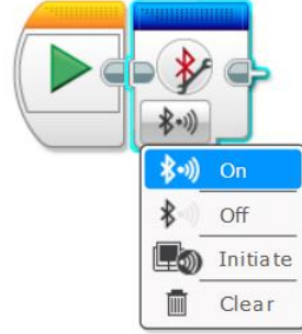
Resim 139. Bluetooth Connection/Bağlantı Bloğu
