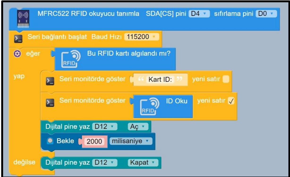
Resim 8.7: Anahtarlık ve Kart Kodlarını Okumak ve Seri Port Ekranında Yazdırma Örnek Program
