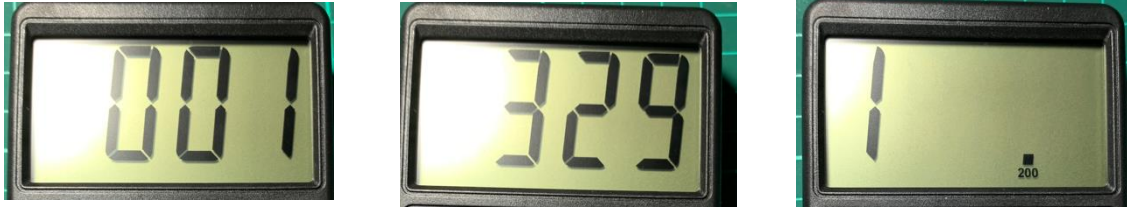
Resim 5.10: 330 ohm Değerindeki Direncin Yüksek, İdeal ve Düşük Kademelerdeki Ölçümleri
