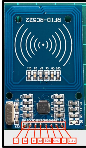
Resim 8.2: RC522 RFID NFC Kiti Bağlantı Uçları
