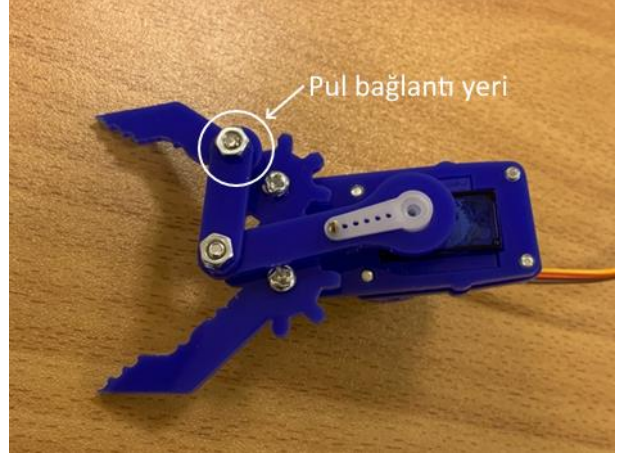
Bağlantı sonrası alttan görünüm.
