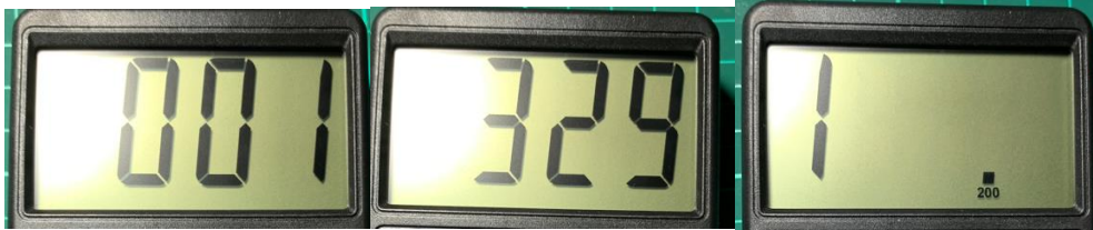
Resim 3.7: Avometre Direnç Ölçümü
