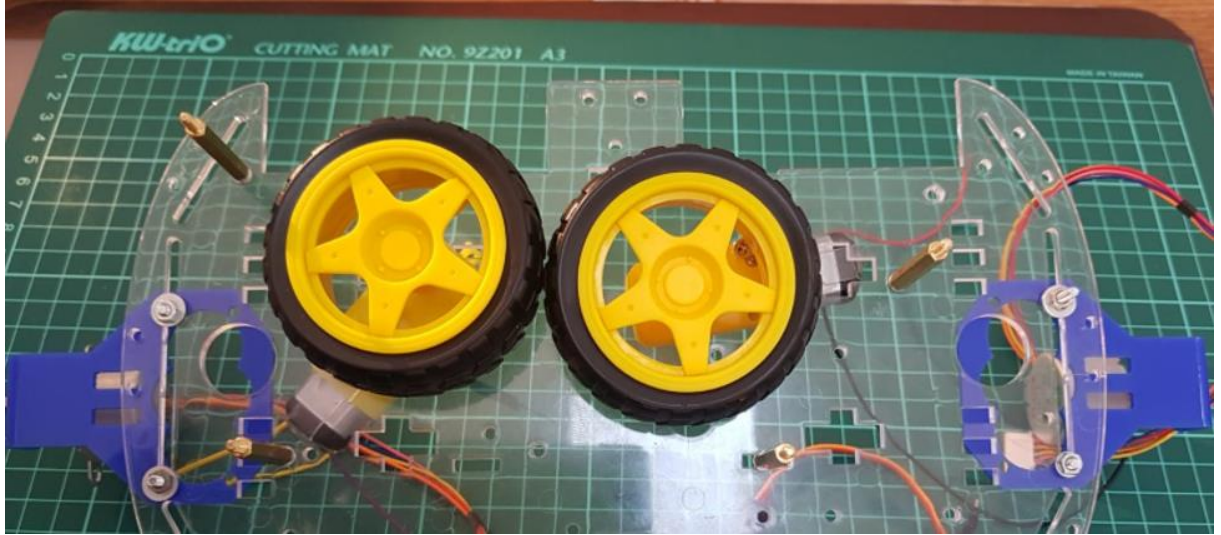
Resim 7.1: Motorların Platformda Örnek Yerleşimi
