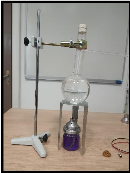
Şekil 4-5 Isı enerjisinden elektrik enerjisi elde etme deney düzeneği
