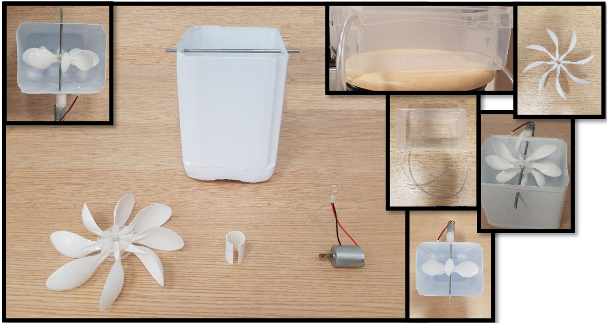
Şekil 5-4 Su gücünden faydalanarak elektrik enerjisi elde etmek için deney elemanları ve düzeneği
