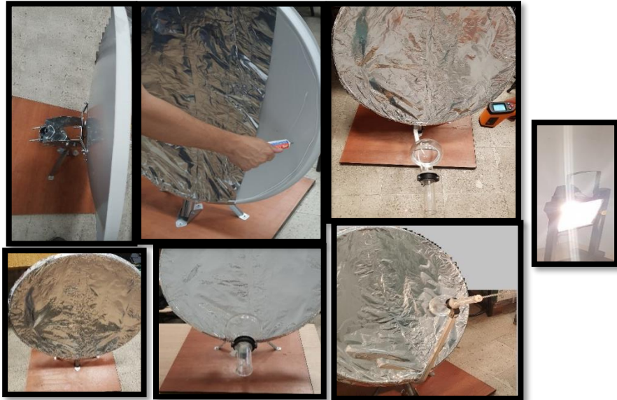
Şekil 6-4 Ayna odaklama ile güneş enerjisinden ısı enerjisi elde etme deneyi
