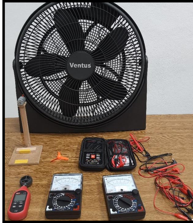
Şekil 8-7 Rüzgâr hızı, üretilen elektrik akım ve gerilim ölçümü deney elemanları
