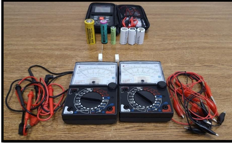
Şekil 11-6 Batarya tiplerinin basit olarak ölçülebilir büyüklüklerini belirleme deney elemanları
