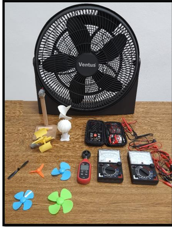
Şekil 9-5 Rüzgâr türbinlerinde farklı kanat tiplerinin enerji üretimine etkisi deney elemanları
