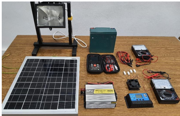
Şekil 7-6 PV panelin şarj kontrollü DC ve AC yükü beslemesi etkinliği deney elemanları
