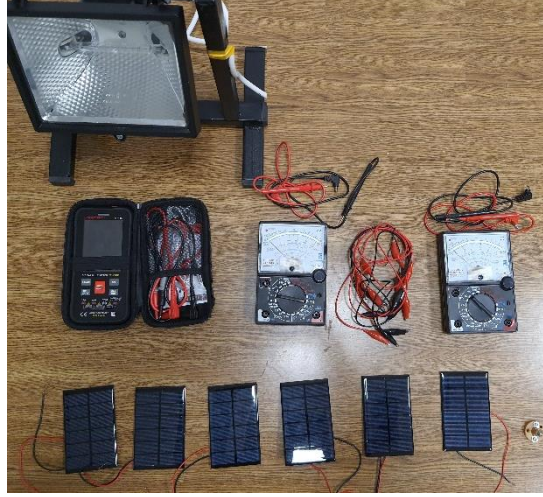
Şekil 7-3 PV hücrelerin seri ve paralel deney elemanları
