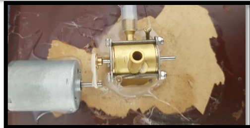
Şekil 4-5 Isı enerjisinden elektrik enerjisi elde etme deney düzeneği
