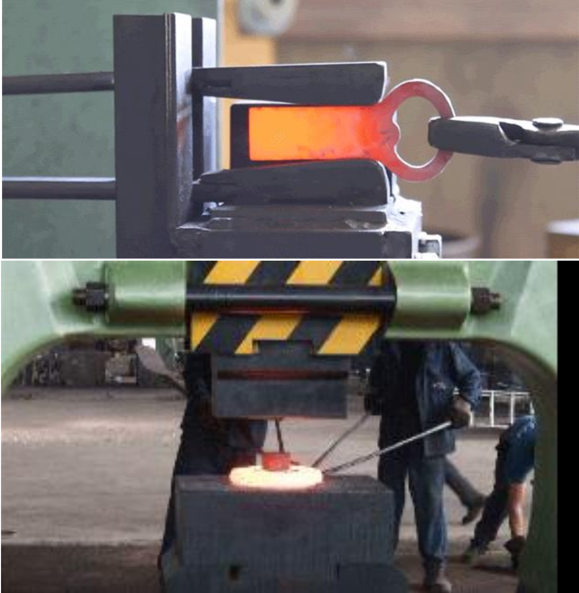
Şekil 1.11. Dövme işlemi temel çalışma prensibi (kaynak: üst: https://gifer.com/en/BIXV , Alt: https://imgur.com/gallery/BaMaB )
