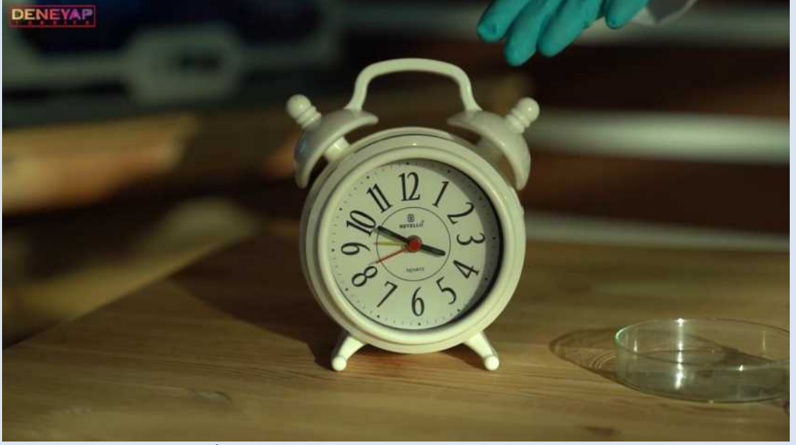
İerisinde Piezoelektrik malzeme bulunan Kuvars saat
