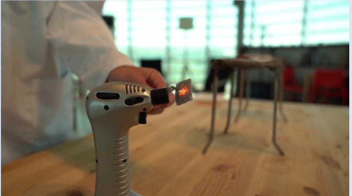
Aerojel kumař parasının pürmüz yardımıyla ısıtılması
