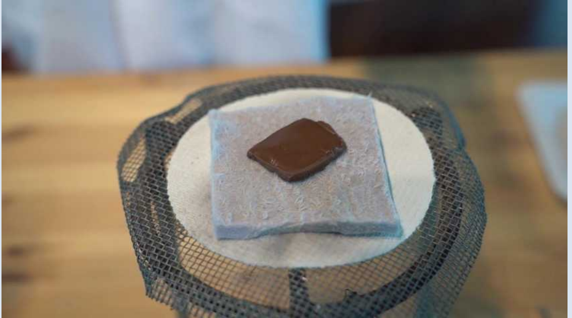
Arojel kumaş parasının ısıtılması sonuca hızlıca erimediđi gözlemlenen ikolata parası
