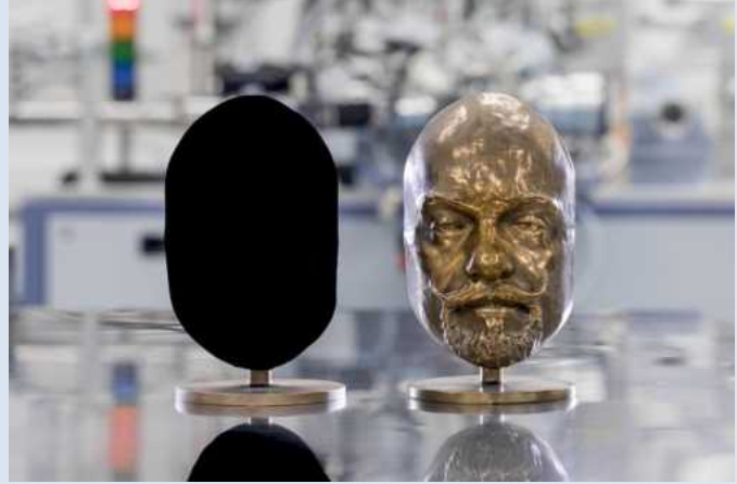
Aynı maskenin Vantablack® ile kaplanmış ve kaplanmamış görünümleri [ https://www.youtube.com/watch?v=v3pkXUhCPOQ ] [ https://www.surreynanosystems.com ]
