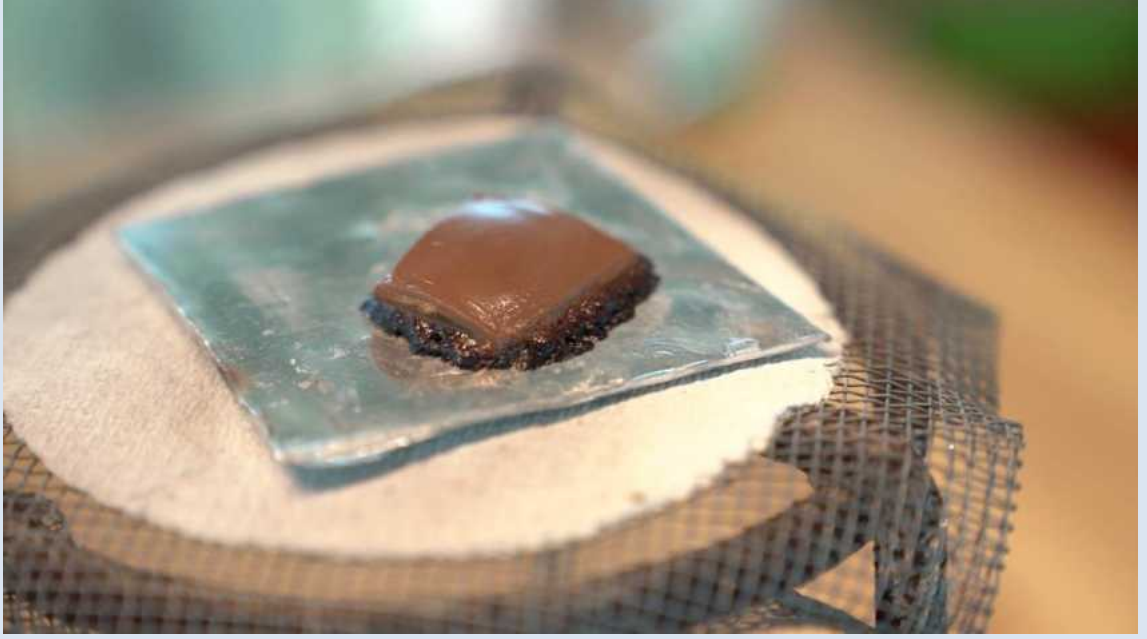
Alüminyum plakanın ısıtılması sonuca eridiđi gözlemlenen ikolata parası
