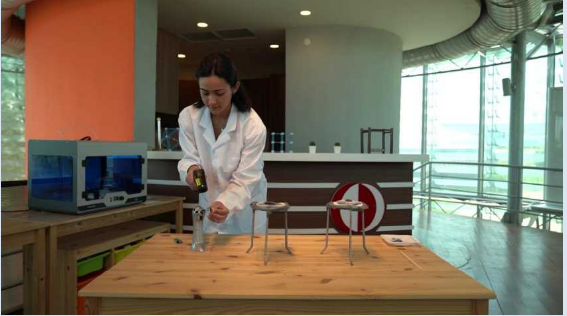
Isıtılan aerojel kumaş parçasının sıcaklığının kızılötesi temassız termometre ile ölçülmesi
