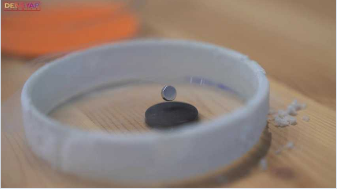
Süperiletken malzeme kritik sıcaklık altına indiğinde üzerindeki mıknatısın havada asılı kalması
