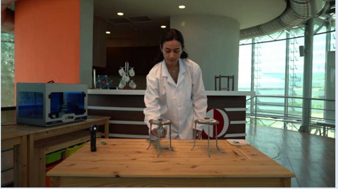
Yanan pürmüz yardımıyla alüminyum plakanın ısıtılması
