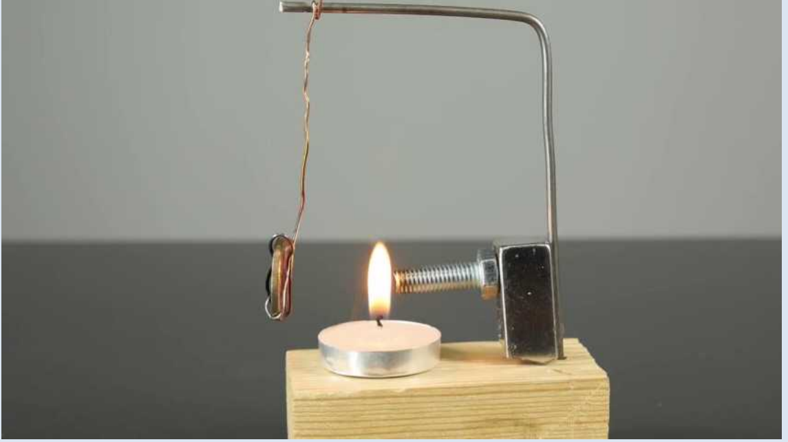
Mum tarafından ısıtılan nikel parçanın mıknatıstan uzaklaşması
