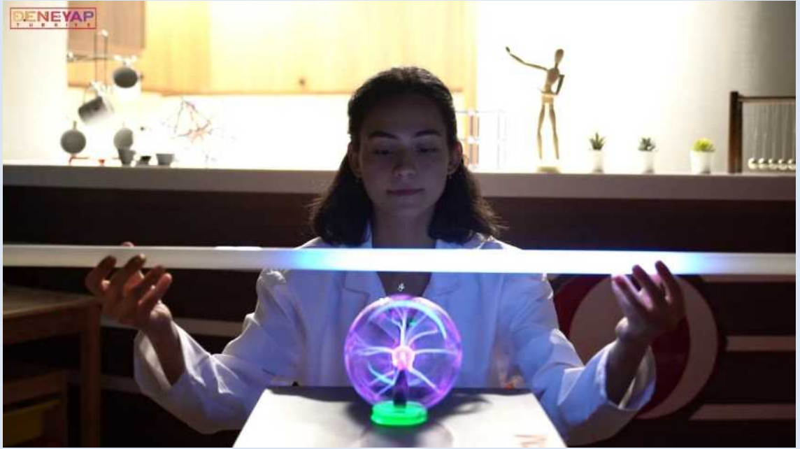
Uzun bir floresan lambanın plazma küresine yaklaştırıldığında yalnızca iki el ile kısıtlanan aralığın ısıldadığının görülmesi
