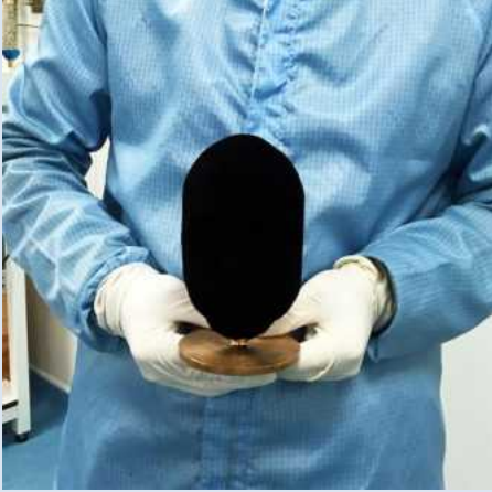
Vantablack® ile kaplanmış bir maskenin görünümü [ https://www.surreynanosystems.com ]
