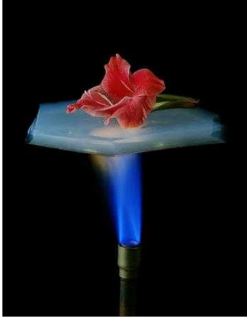
Oksijen kaynağı ile doğrudan verilen ateşi yalıtıp üzerindeki çiçeği ateşten koruyan bir aerogel https://commons.m.wikimedia.org/wiki/File:Aerogelflower_filtered.jpg#mw-jump-to-license
