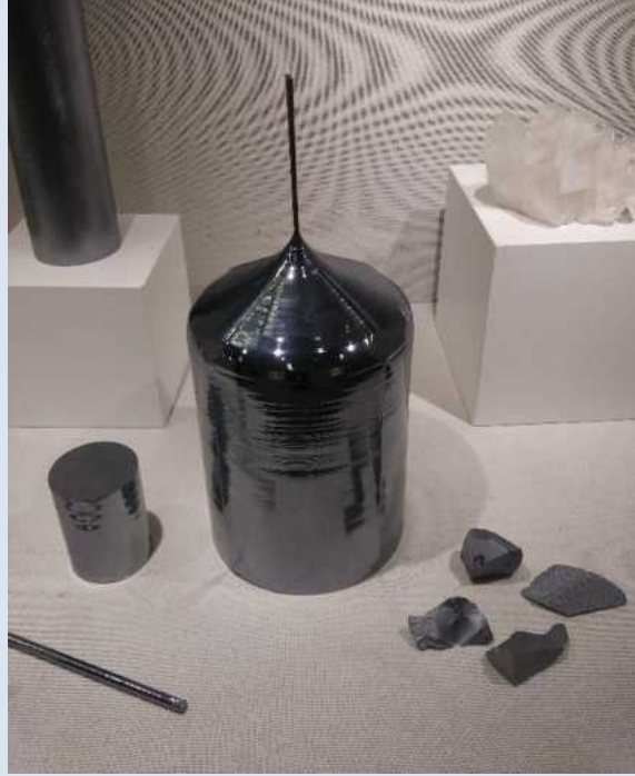
Czochralski Yöntemiyle Büyütülen Silisyum Kristali Külçe.
