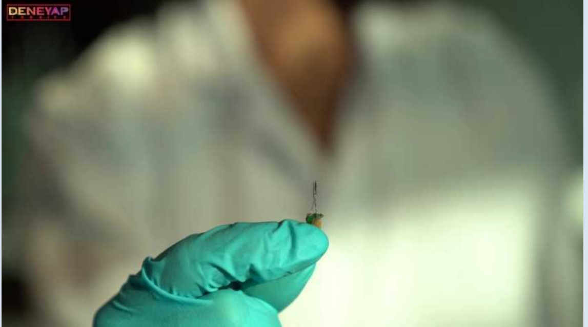
Kuvars saat ierisinde bulunan piezoelektrik malzeme
