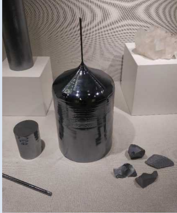
Czochralski Yöntemiyle Büyütülen Silisyum Kristali Külçe.
