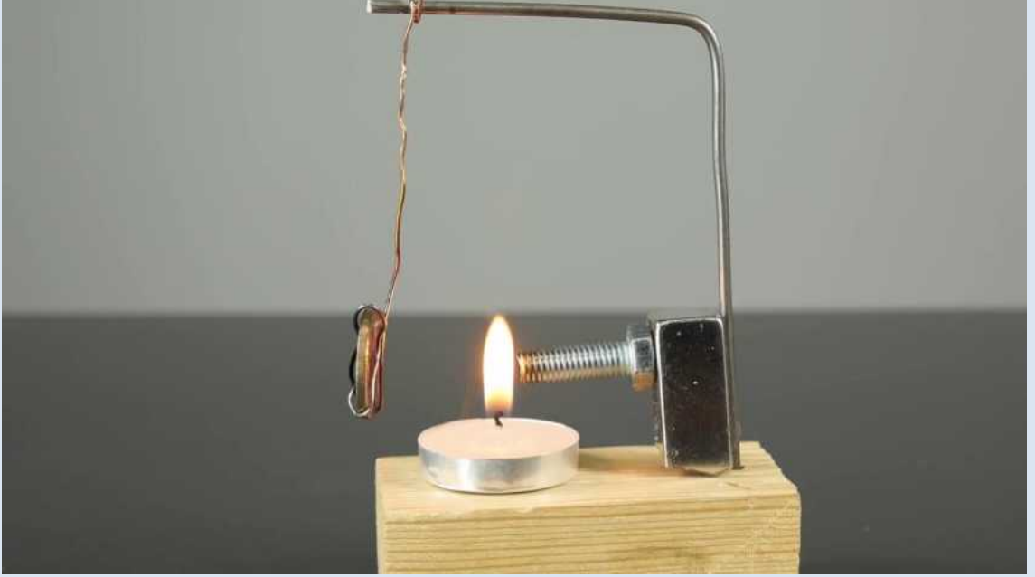
Mum tarafından ısıtılan nikel parçanın mıknatıstan uzaklaşması
