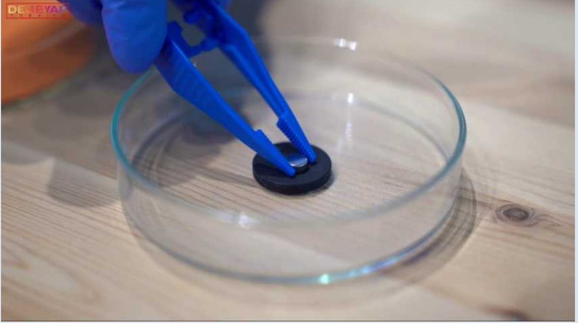
Petri kabı içerisindeki süperiletken malzeme üzerine neodyum mıknatısın yerleştirilmesi
