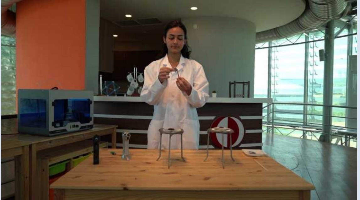
Yüksek sıcaklıklarda olduğu gösterilen aerojel kumaş parçasının el ile rahatça tutulabildiğinin gösterimi
