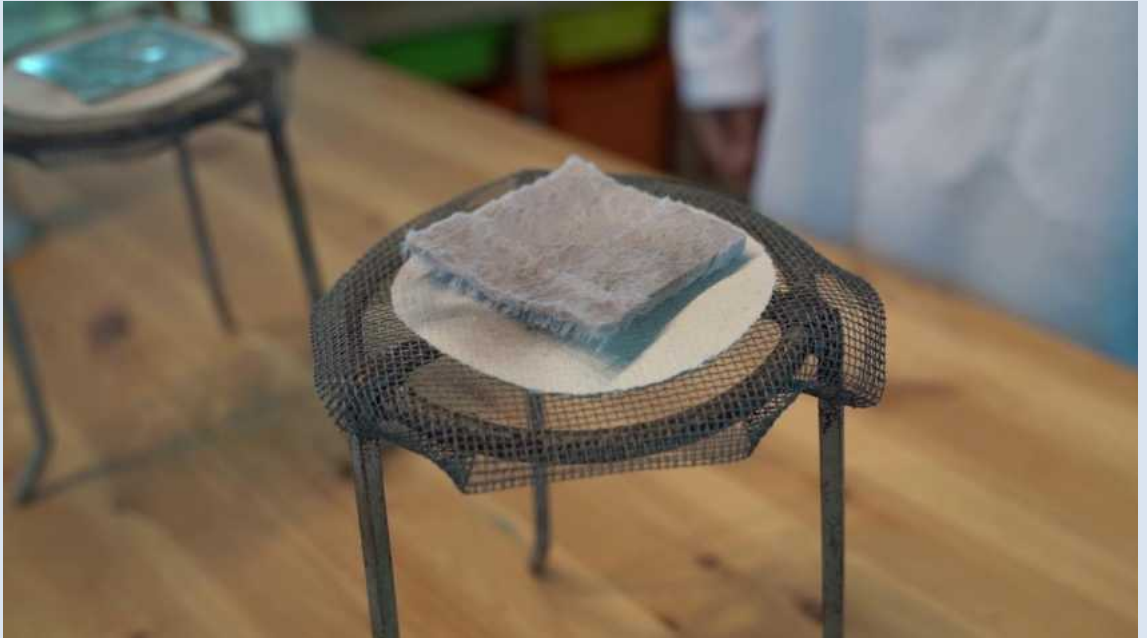
Üç ayaklardan birinin üzerine yerleştirilmiş aerojel kumaş parçası
