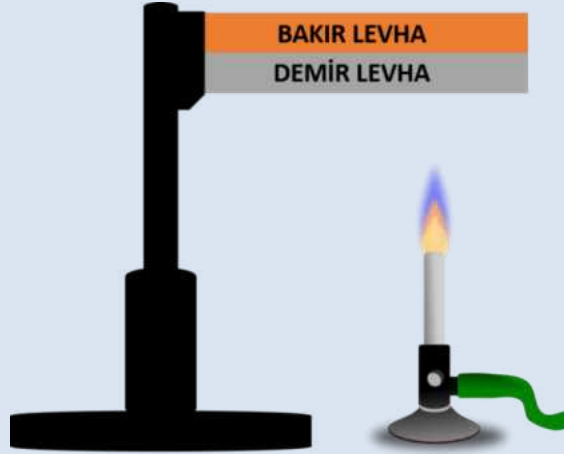
Metal çifti deneyi deney düzeneği
