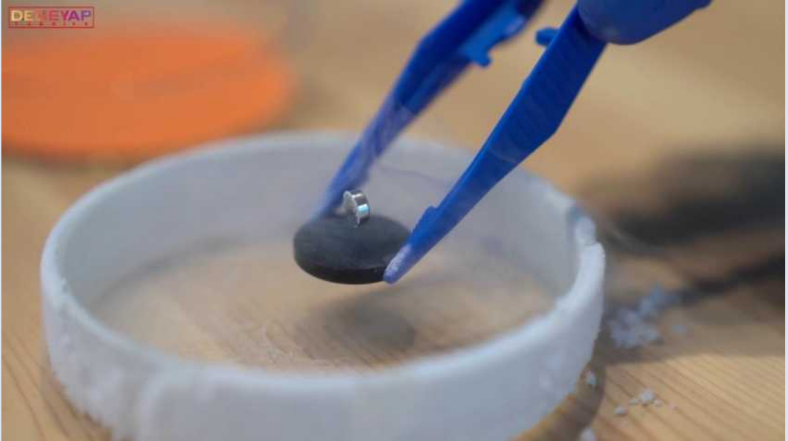
Havada asılı kalan mıknatısın süperiletken malzeme hareket ettirildiği durumda dahi pozisyonunu koruması
