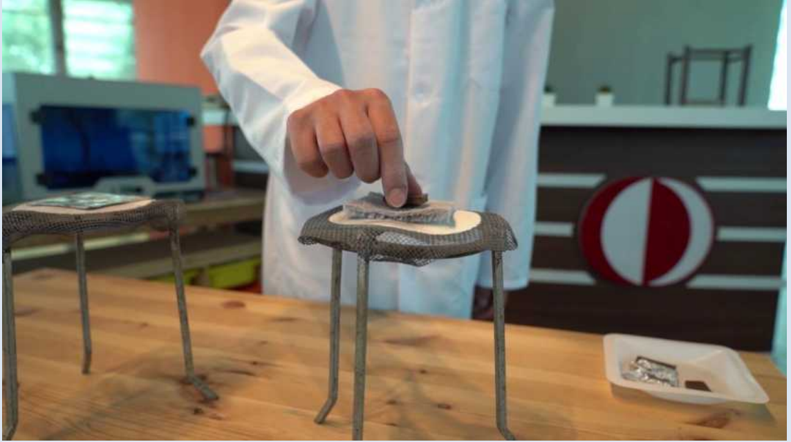
ikolata parasının aerjel kumař parası zerine yerleřtirilmesi
