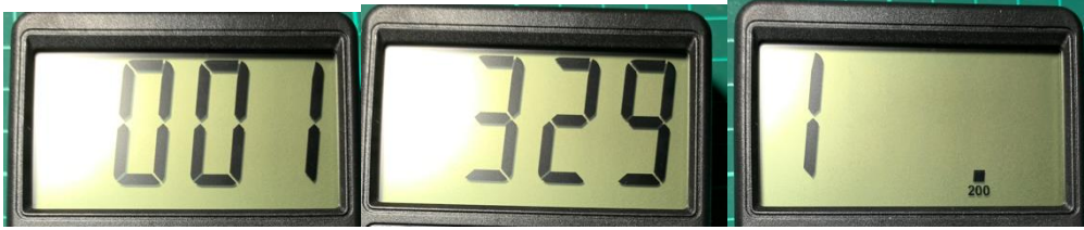
Resim 3.7: Avometre Direnç Ölçümü
