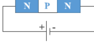
Resim 4.8: NPN Transistör Devre Bağlantısı
