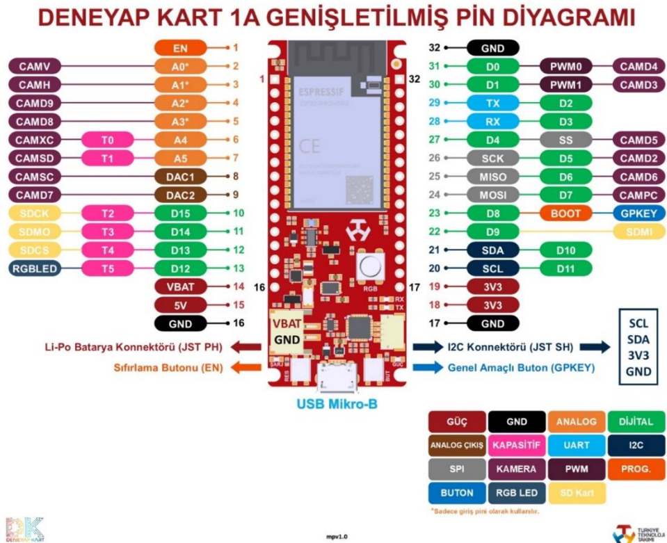
Resim 2.4: Deneyap Kart Genişletilmiş Pin Diyagramı
