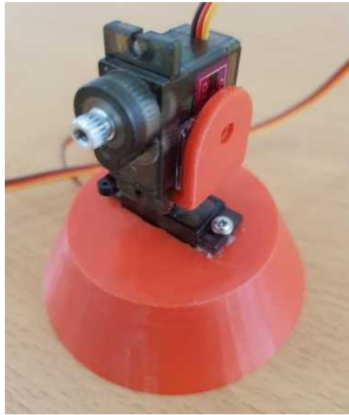
Resim 78 İki Numaralı Servo Motorun L-Profil Parça Üzerine Konumlandırılması.
