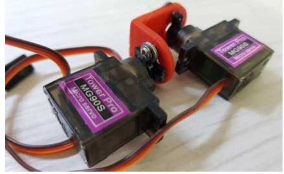
Resim 24 3B Yazıcı ile Basılmış L-Profil Kullanılarak Hazırlanmış Çift Motor Düzeneği
