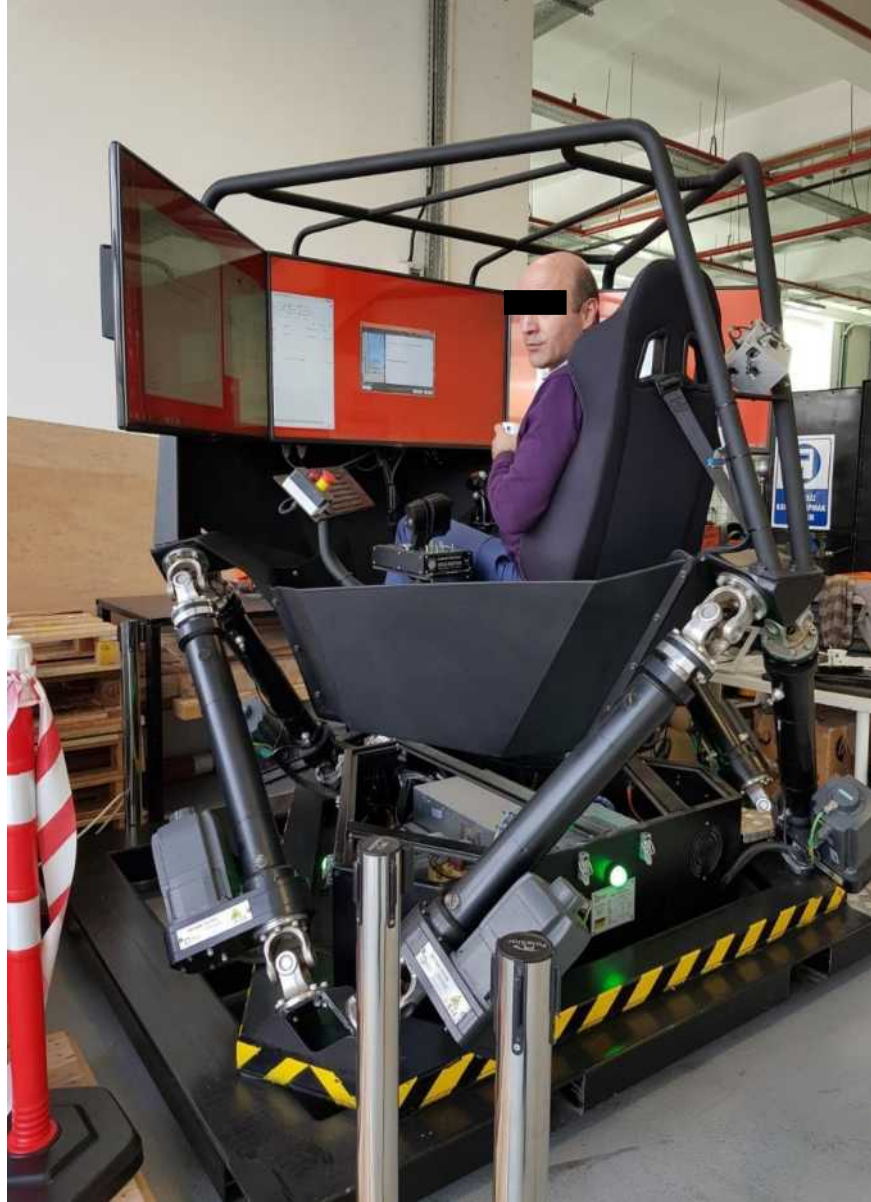
Resim 6 Bir Paralel Robot Mekanizması (Ghorbani, 2018)
