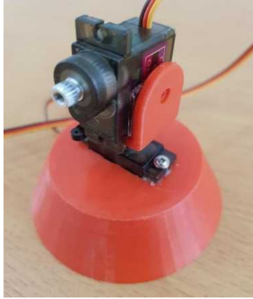
Resim 55 İki Numaralı Servo Motorun L-Profil Parça Üzerine Konumlandırılması
