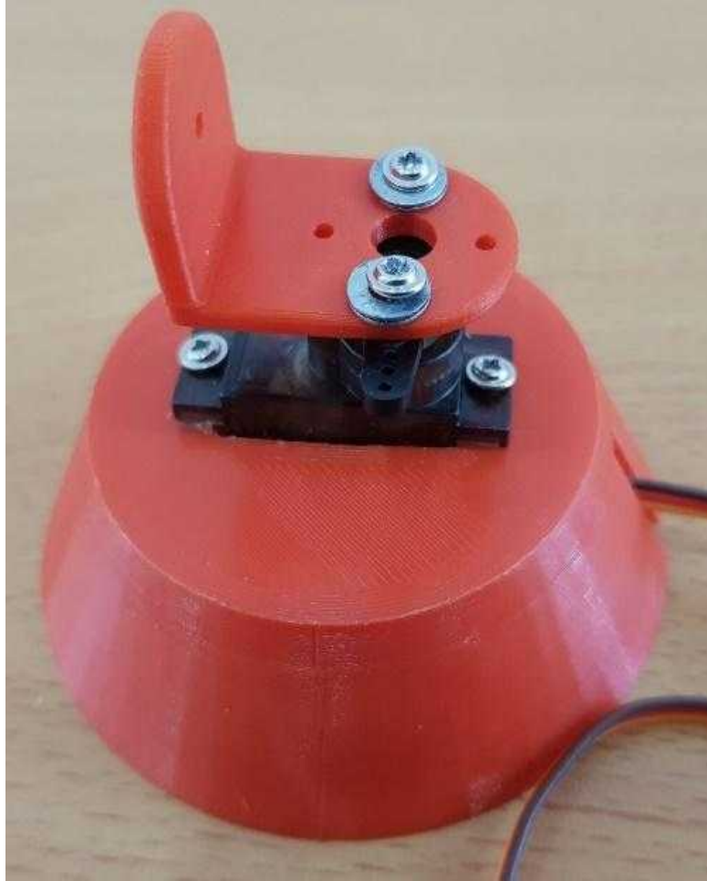
Resim 53 Hazırlanan L-Profil Parçasının Taban Motoru Miline Yerleştirilmesi
