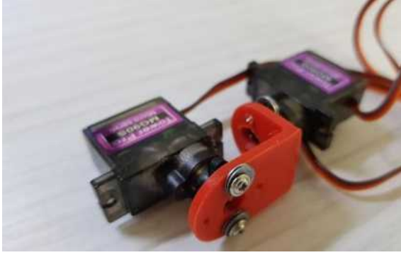
Resim 24 3B Yazıcı ile Basılmış L-Profil Kullanılarak Hazırlanmış Çift Motor Düzeneği
