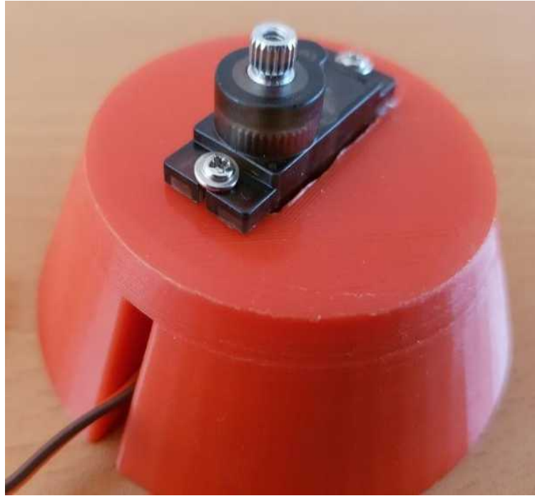
Resim 74 Taban Parçaya Vidalanmış Servo Motor.
